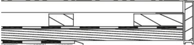
Ortgangausbildung mit Ortgangziegel rechts mit Ortgangbrett
